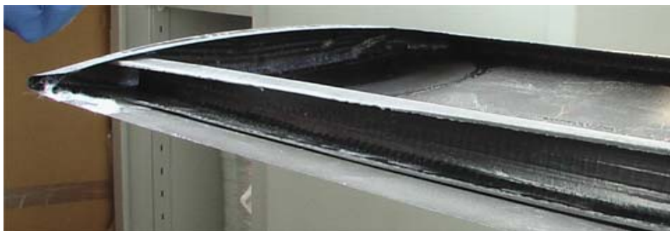
Lo stampo del ventre del piano di coda orizzontale
